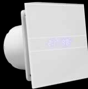
Leaf Axial 4 Ventilator zur Entlüftung von jeder Art von Innenräumen mit Lüftungsstrecken bis 3 m, Anzeige von Feuchte und Temperatur der Raumluft, mit Feuchteautomatik
