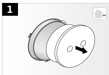
Anschließend nehmen Sie den Wandanschluss [6] von der Außenblende [7] und schieben diesen über das Wanddurchführungsrohr. Nutzen Sie den Wandanschluss als Schablone und zeichnen Sie die Bohrlöcher zur Befestigung an (Abb. 2).
