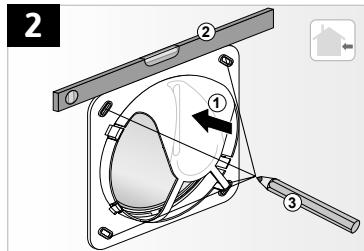
Achten Sie hierbei auf den richtigen Sitz des Wandanschlusses und kontrollieren Sie diesen mit einer Wasserwaage. Nehmen Sie den Wandanschluss wieder von dem Rohr ab und stecken Sie den Putzstopfen erneut in das Rohr, um zu verhindern, dass Bohrstaub in das Rohr gelangt. Nach dem Bohren der vier Löcher setzen Sie den Wandanschluss wieder auf das Rohr und befestigen ihn mit für die Wandbeschaffenheit passenden Dübeln und Schrauben an der Hauswand (Abb. 3)
