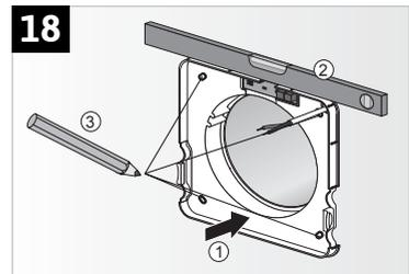
Bohren Sie jetzt die Löcher und versehen Sie diese mit für die Wandbeschaffenheit passenden Dübeln. Setzen Sie dann den Wandanschluss wieder auf das Wanddurchführungsrohr, achten Sie dabei auf den richtigen Sitz und das die Kabelführung durch die dafür vorgesehene Öffnung verläuft. Befestigen Sie nun den Wandanschluss mit vier Schrauben an der Wand (Abb. 19).
