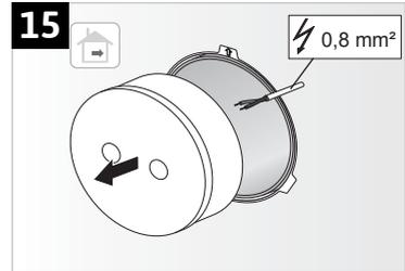
Lösen Sie die Innenblende von dem Wandanschluss [9]. Drücken Sie die Snap-on Verbindungen (rechts und links), ziehen Sie die Innenblende leicht nach vorne und heben Sie sie nach oben vom Wandanschluss ab (Abb. 16).
