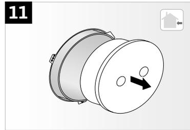
Anschließend nehmen Sie den Wandanschluss [6] von der Außenblende [7] und schieben diesen über das Wanddurchführungsrohr. Nutzen Sie den Wandanschluss als Schablone und zeichnen Sie die Bohr-löcher zur Befestigung an (Abb. 12).
