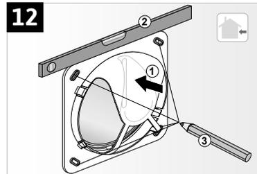
Achten Sie hierbei auf den richtigen Sitz des Wandanschlusses und kontrollieren Sie diesen mit einer Wasserwaage. Nehmen Sie den Wandanschluss wieder von dem Rohr ab und stecken Sie den Putzstopfen erneut in das Rohr, um zu verhindern, dass Bohrstaub in das Rohr gelangt. Nach dem Bohren der vier Löcher setzen Sie den Wandanschluss wieder auf das Rohr und befestigen ihn mit für die Wandbeschaffenheit passenden Dübeln und Schrauben an der Hauswand (Abb. 13)
