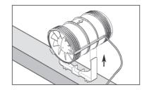
Eventuelle Verschmutzungen können Sie mit Hilfe eines Pinsels, eines Mikrofasertuches oder eines Staubsaugers entfernen. Nach der Reinigung, befestigen Sie den Axial 1 wieder in der Halterung und schließen die Flexrohre erneut an. Achten Sie darauf, dass die Schellen der Flexrohre wieder fest verschlossen sind, damit durch diese keine Luft ausdringen oder abfallen kann. Diese Reinigung sollte einmal im Jahr oder nach Bedarf durchgeführt werden.
